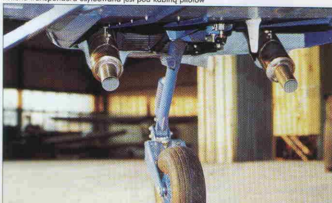
Antena transpondera usytuowana jest pod kabiną pilotów
