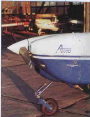
Koło przednie z tłumikiem shimmy
