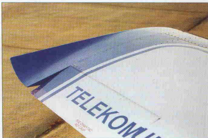
Końcówka skrzydła wykonana jest z tkaniny szklanej
