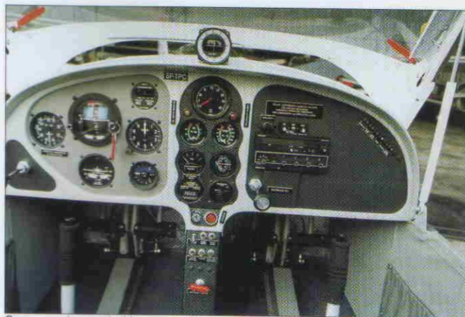
Czerwony uchwyt pod tablicą przyrządów to przełącznik awaryjnego trybu pracy silnika
