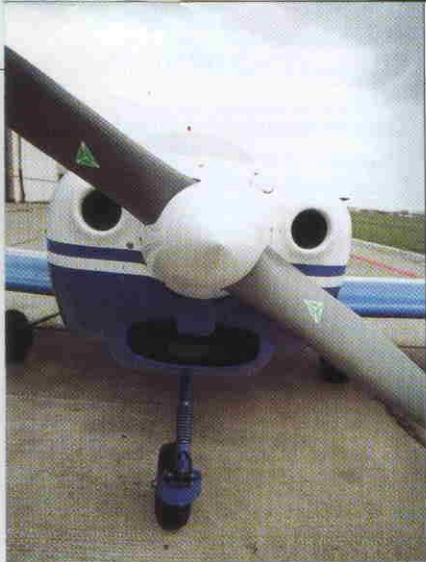
Chłodzenie cylindrów („oczka”), oraz cieczy i oleju („paszcza”)
