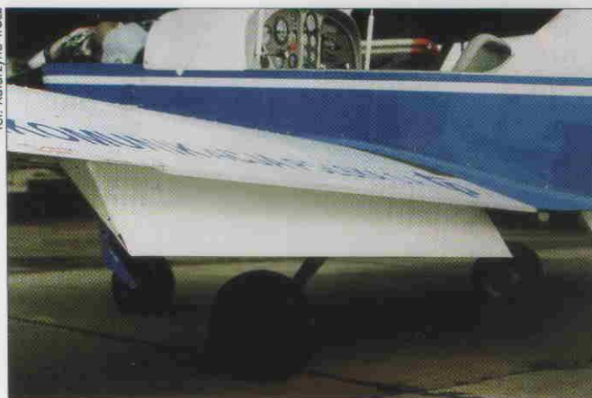
Krawędź spływu nad klapką to tzw. klapka Garney'a
