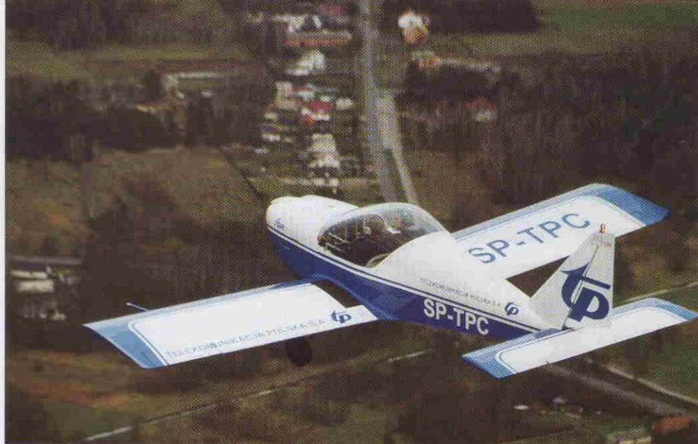
W samolocie zastosowano usterzenie poziome płytowe (tzw. pływakę)
