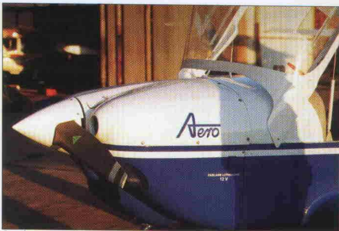
Omaskowanie silnika wykonane jest z tkaniny węglowo-kewlarowej
