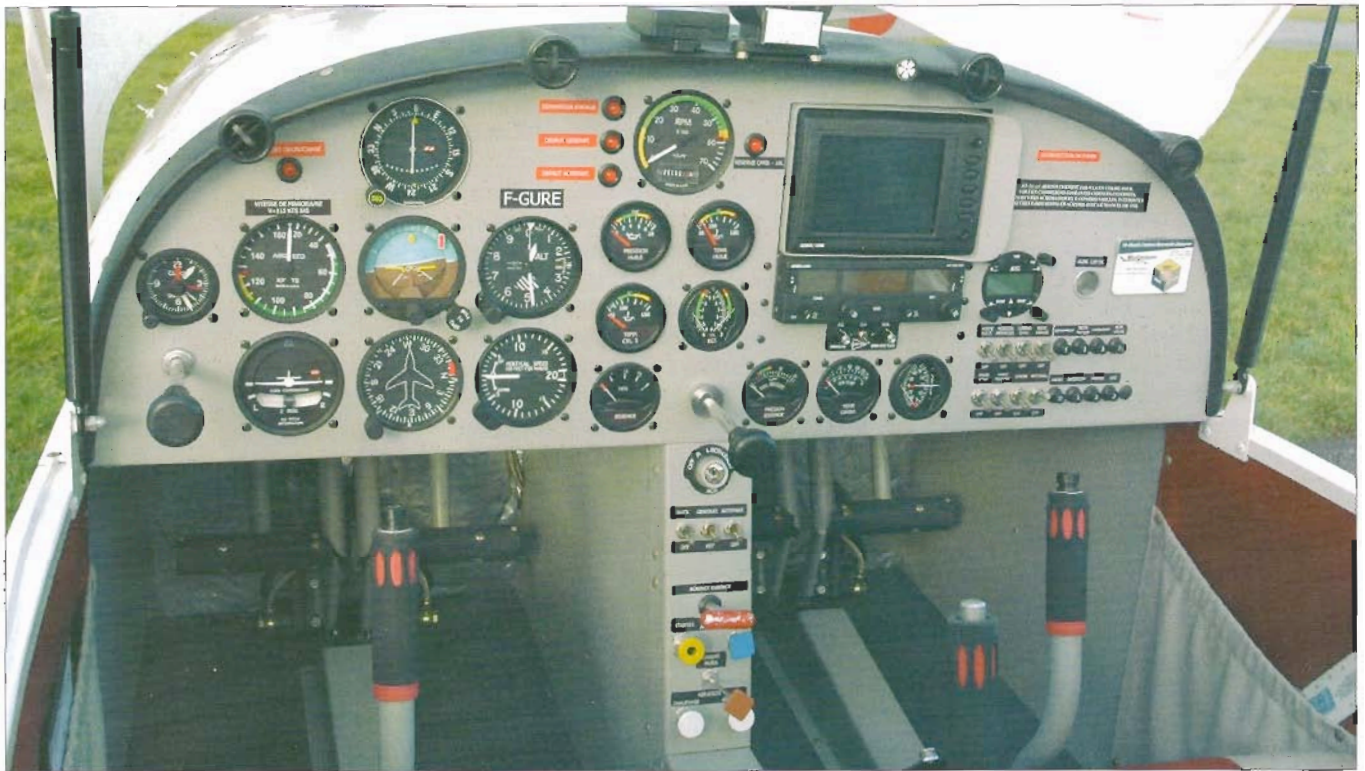
La place ne manque pas dans l'habitacle de l'AT-3, ce qui autorise, à la demande du client, les installations d'avionique les plus complexes. Sièges et palonniers ne sont pas réglables mais chacun trouve sa place à bord naturellement. Le robinet d'essence, en rouge, est inhabituel par son débattement de 20 cm qui bloque presque les commandes lorsque l'essence est fermée. L'équipement standard comprend un GPS et une COM/NAV King. Le transpondeur mode S est un Filser. L'AT-3 dispose de deux sources électriques séparées, ce qui lui permet de se passer de pompe à vide.
