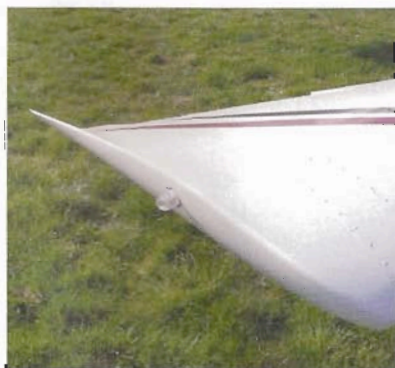
Les rivets à tête bombée révèlent la construction en métal.
