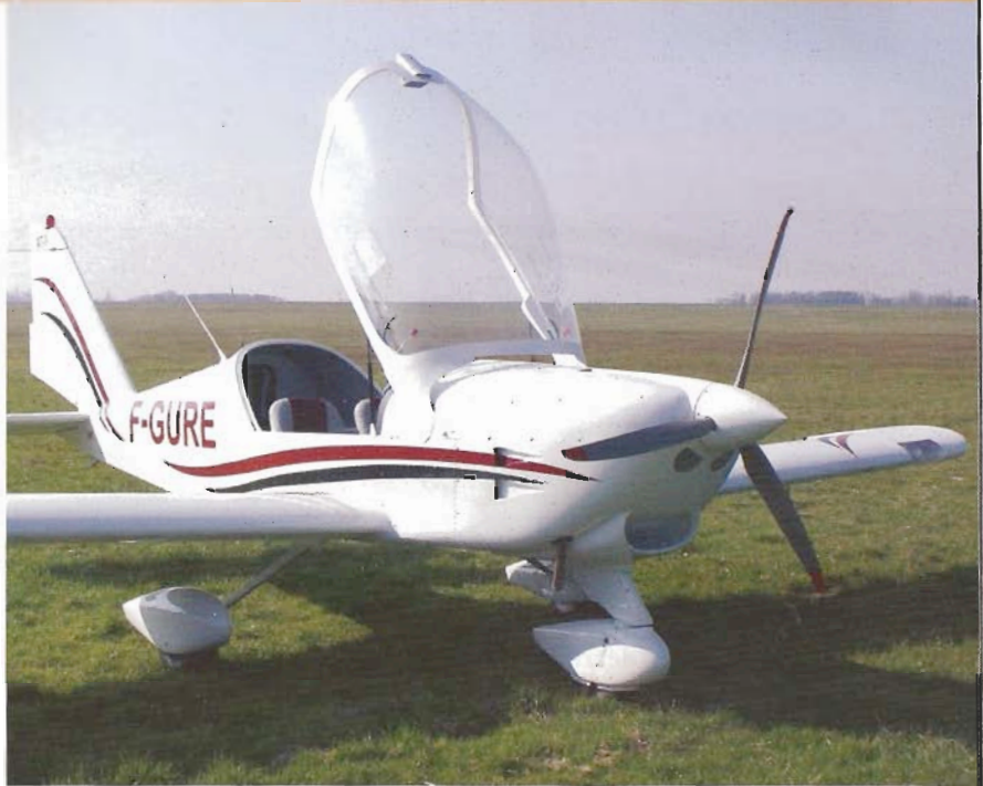
La verrière s'ouvre vers l'avant, dégageant bien l'accès à bord. Le démonstrateur a reçu une hélice tripale proposée en option.
